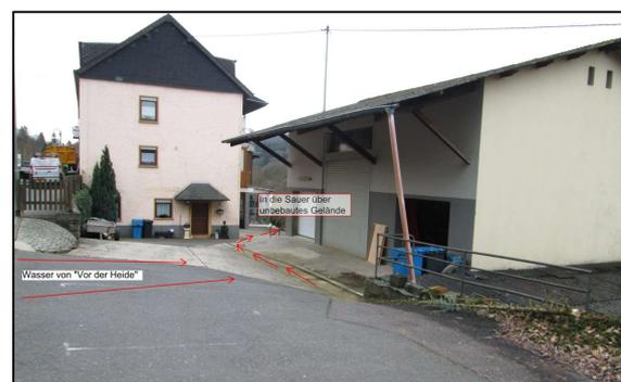
Abbildung 77: möglicher Notwasserweg
