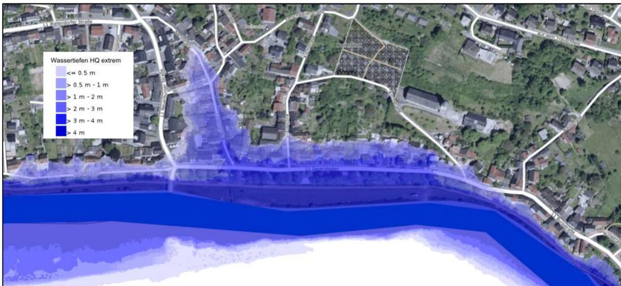
Abbildung 15: Wassertiefen an der Sauer bei HQ<sub>extrem</sub>
