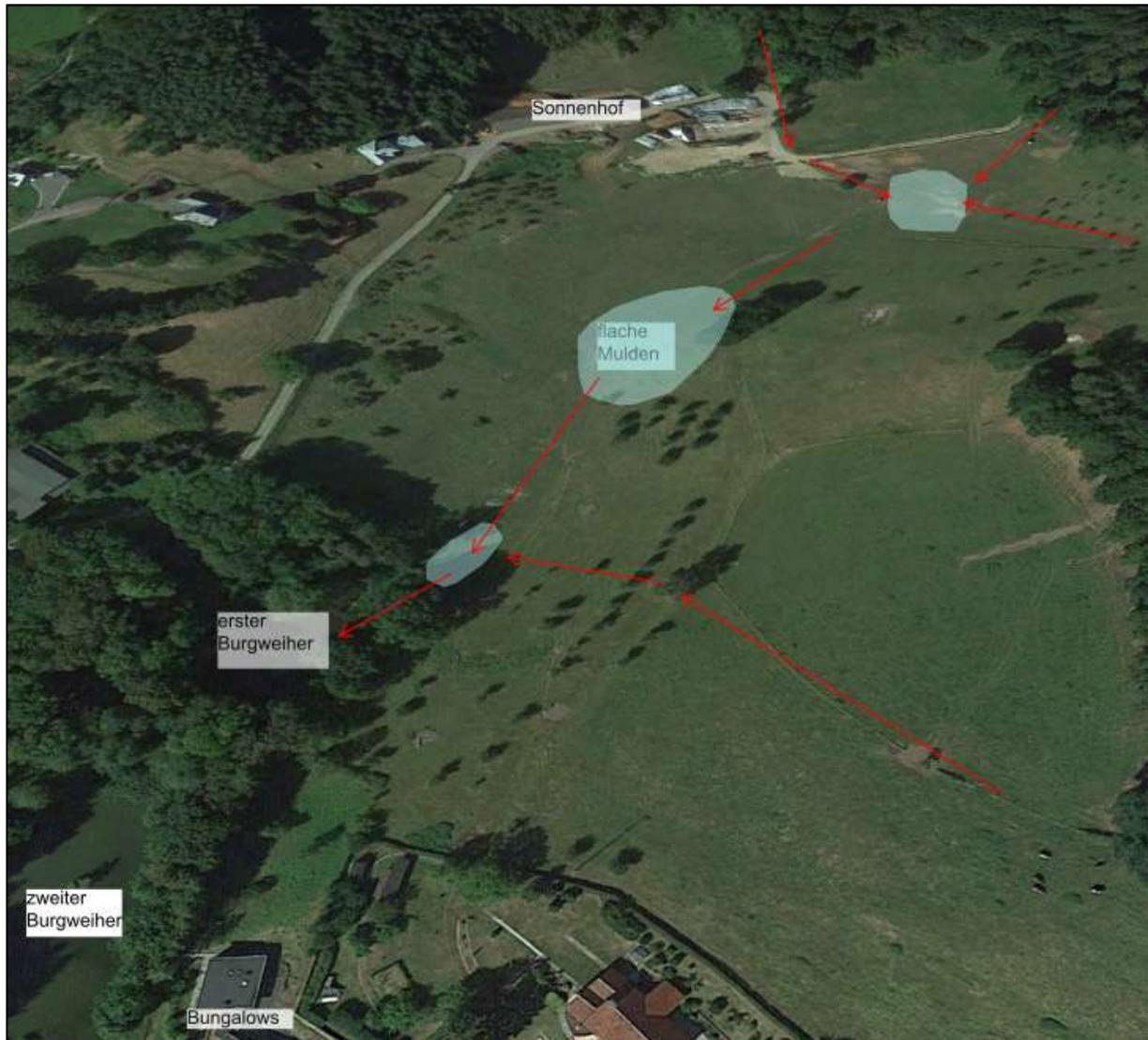
Abbildung 73: Möglichkeiten der Zwischenspeicherung in der Fläche oberhalb Burgweiher
