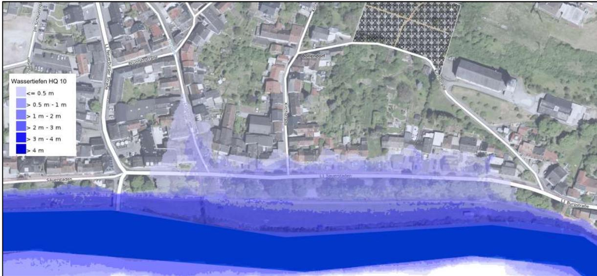
Abbildung 14: Wasserstand im Überflutungsbereich bei HQ<sub>10</sub>
